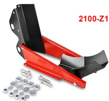
Con questo cavalletto universale per moto puoi posizionare le moto con ruote anteriori da 16 a 19 pollici in una posizione stabile. La larghezza massima possibile della ruota è di 135 mm. Il cavalletto per moto deve essere imbullonato a terra con le viti in dotazione.
