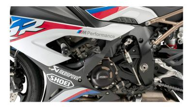
Queste protezioni motore sono realizzate in polipropilene ultraleggero da 4 mm e sono composte da tre parti. Il set contiene una copertura per il carter destro e sinistro e una copertura per alternatore. I cappucci proteggono il carter motore e l'alternatore dai danni, hanno una finitura nera opaca e sono avvitati sul carter motore.
