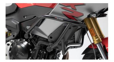
Anche i nostri paracilindri sono realizzati in acciaio di alta qualità appositamente per la BMW F900XR (2020-2021) e si armonizzano benissimo all'aspetto generale della moto. Il paracilindro ha una configurazione molto stabile e provvede ad una distribuzione uniforme delle forze, garantendo a Voi e alla Vostra moto una protezione ottimale. I paracilindri offrono una protezione molto buona, ma possono limitare la posizione inclinata.
