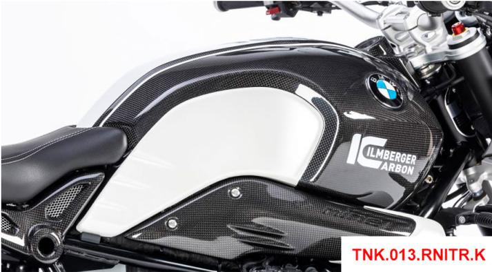
Il serbatoio di carbonio per la BMW RnineT, RnineT Scrambler, Racer & Urban G/S è una sostituzione diretta per la parte originale e contribuisce principalmente all'alleggerimento della motocicletta e ad una maggiore rigidità delle parti. Fornisce anche un aspetto eccezionale alla tua moto.
