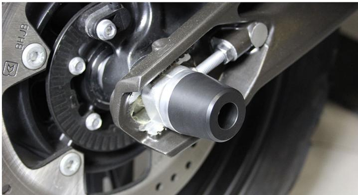
Questi tamponi para forcellone posteriore sono in plastica ad alta resistenza (POM). Il sostegno e` in alluminio anodizzato e cnc.
