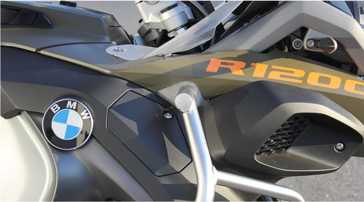
Queste coperture per i fori aperti della carenatura della barra anticaduta per la BMW R1200GS Adventure (2014-2018) sono realizzate in alluminio e disponibili in argento anodizzato. Queste due coperture saranno installate sul lato destro e sinistro.
