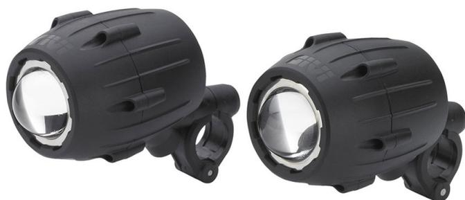
Queste luci alogene aggiuntive vanno benissimo per tutte le moto con dispositivi anti-collisione (crash bar) o simili soluzioni di montaggio. Il set consiste di due fari aggiuntivi a luce alogena, che possono essere installati sulle crash bar (diametro 21-26mm). Saranno collegati alla batteria. L'interruttore verrà installato sul vostro manubrio. Queste luci non richiedono alcuna modifica al sistema elettrico della vostra moto.
