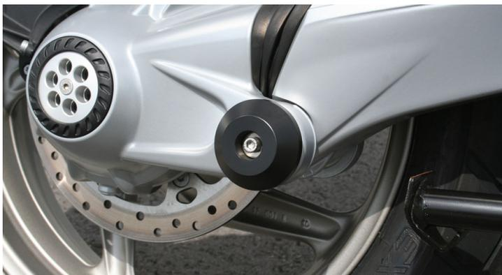
Questo cilindro per il cardano e' in materiale plastico CNC. Questo cilindro offre maggiore protezione alla vostra moto. Potete installare il cilindro al cardano con una vite in acciaio inox e un tassello ad espansione.
