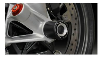
Questi tamponi paracaduta per la parte anteriore della vostra moto sono rivestiti in CNC e fatti di plastica POM di alta qualita'. Il sostegno e` in alluminio anodizzato.
