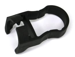
Il connettore di candele delle moto della nuova generazione permette di rimuovere le candele in modo facile e sicuro. Il connettore e' anche la bobina d'accensione. Questo attrezzo facilita l'estrazione del connettore di candele / bobina ad alta tensione. Cercare di estrarre il connettore con l'attrezzo sbagliato non e' solo difficile ma puo' anche creare danni irreparabili al connettore.
