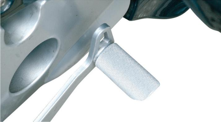
Questa estensione della leva del freno in alluminio anodizzato naturale impedisce, grazie alla sua superficie zigrinata, che il piede scivoli sul bagnato e garantisce così maggiore sicurezza durante la guida. Si fissa da sotto tramite una vite a testa incassata. Lungitudine: circa 5,5cm, Diametro: circa 2,4cm Adatta per: R 1100/1150 RT R 1200 RT R 850/1100 R fino al '02 R 1100 RS K 1200 RS & GT
