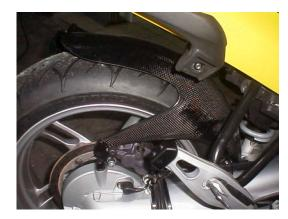
Questo parafango in carbonio per i cerchi posteriori protegge in modo efficace ammortizzatore, sistema di scarico, collettore e parte inferiore del telaietto! Inoltre protegge i piedi del pilota dall'acqua, in caso non si spaventi di uscire col maltempo.
