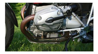
In alluminio tagliato a laser a 3mm e debitamente piegato. Disponibile in 2 varianti (con/senza griglia) in 2 colori rispettivamente (natur/nero anodizzato). (dettaglio da 1 a 4) Montaggio semplice e rapido sui punti originali di fissaggio. Rispettivamente un set (per sinistra e destra), materiale per il montaggio e istruzioni di montaggio compresi nella spedizione.
