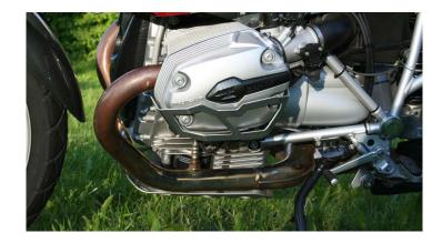
In alluminio tagliato a laser a 3mm e debitamente piegato. Disponibile in 2 varianti (con/senza griglia) in 2 colori rispettivamente (natur/nero anodizzato). (dettaglio da 1 a 4) Montaggio semplice e rapido sui punti originali di fissaggio. Rispettivamente un set (per sinistra e destra), materiale per il montaggio e istruzioni di montaggio compresi nella spedizione. Attenzione: non combinabili con altri paracilindri. Date un'occhiata al nostro comunicato stampa!
