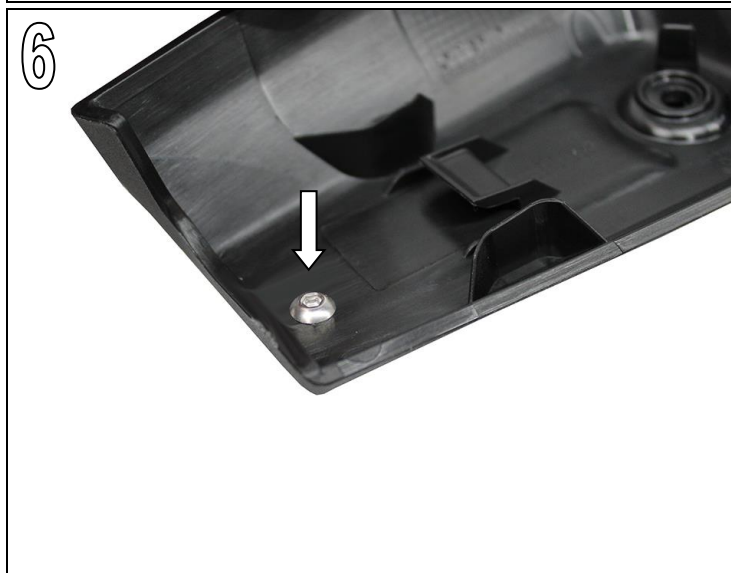
Fig. 6 Avvitare il coperchio AC Schnitzer alla barra di fissaggio inferiore utilizzando la vite a testa cilindrica M4x5mm fornita per il rivestimento standard.
