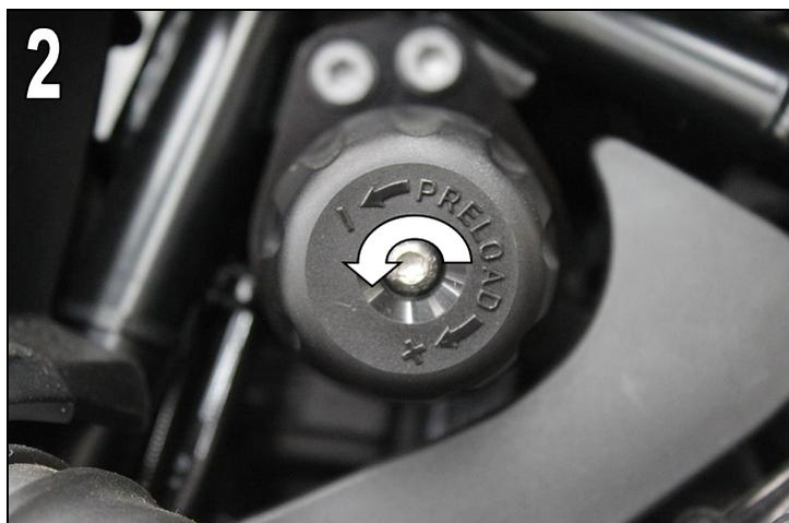
Con un cacciavite Torx adatto, allentare la vite di fissaggio del volantino originale per la regolazione della serranda e rimuovere il volantino.
